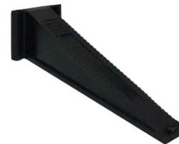
КЛИПСА – одноразовый элемент системы выравнивания. После высыхания клея выбивается и обламывается точно у основания благодаря техническому срезу.
